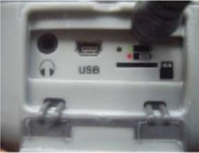
La batería de la cámara es cargada por el punto de recargamiento localizado en la lateral.
