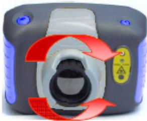
Suavemente gire la lente de la cámara en el sentido horario o anti-horario para ajustar el foco.
